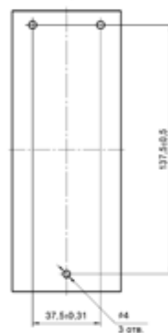
Вариант винтового крепления на панель
