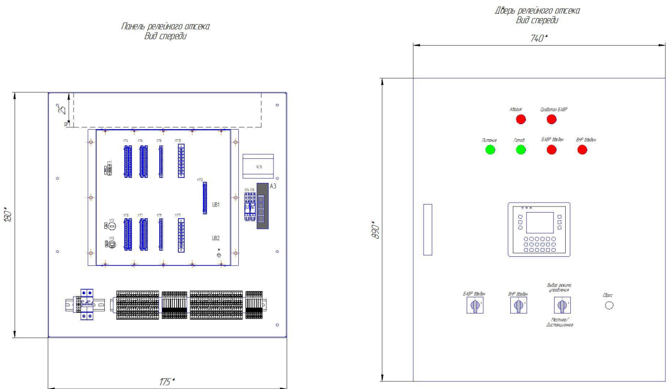
Рисунок 5 – Терминал микропроцессорного пускового устройства расположенный в релейном отсеке.
