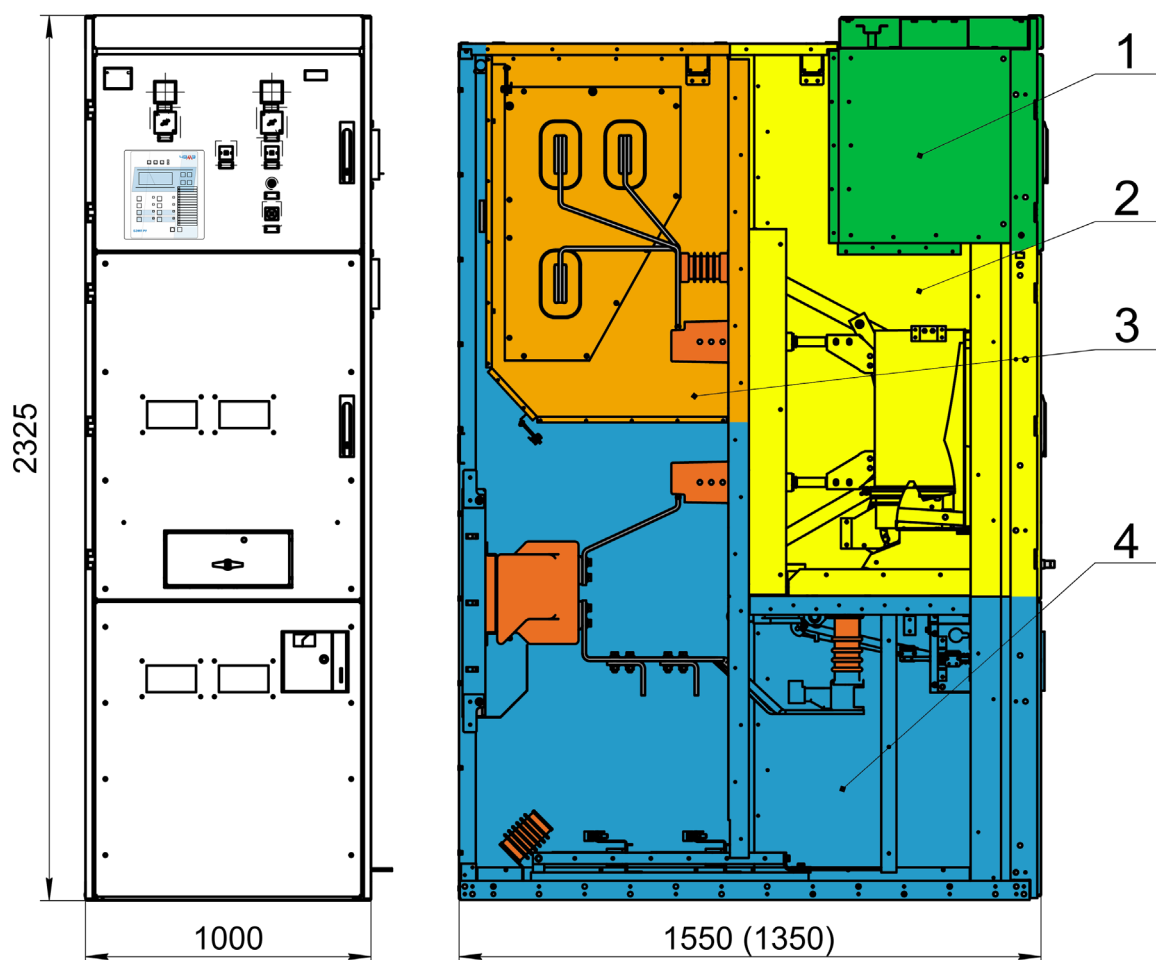
Шкаф КРУ серии КМП-С на номинальные токи до 3150 А
